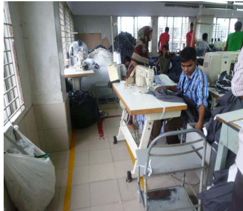
疏散通道临时性被堵
